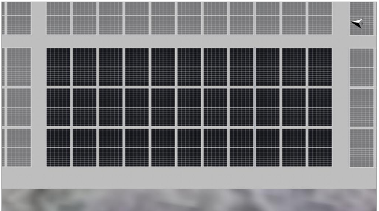
Abbildung: 4. Modulfläche - Gebäude 01-Dachfläche West
